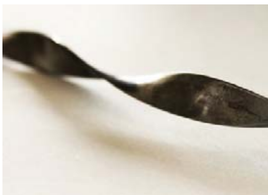
شکل شماره ۱: بهبود دهنده نواری تابیده (Twisted Tape)
